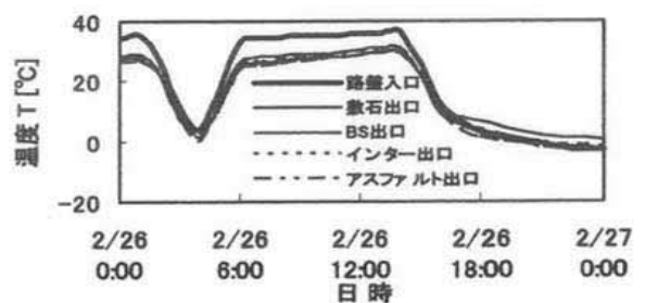
図 13 路盤出入口温度(ヒートポンプ)
