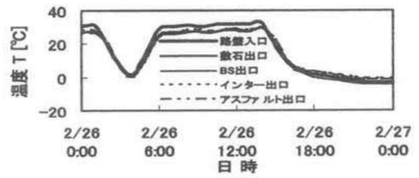
図 11 路盤出入口温度(ボイラー)
